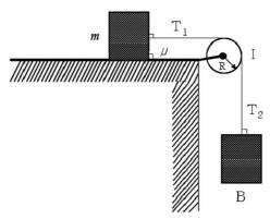
물체가 등가속도로 움직이고 있을 때, 도르래에 토크를 발생시키는 장력의 차이  $T_2-T_1$  은? (단, 원판 도르래의 관성모멘트 I 는  $\frac{1}{2}mR^2$ , g 는 중력가속도이다. 줄의 질량은 무시하고, 줄은 도르래에서 미끄러지지 않는다.)
